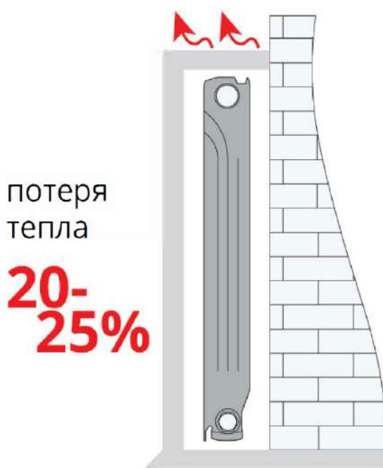
полностью закрыт экраном
